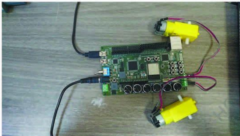
Рисунок 17.3 Подключение моторов к контроллеру КПМИС
